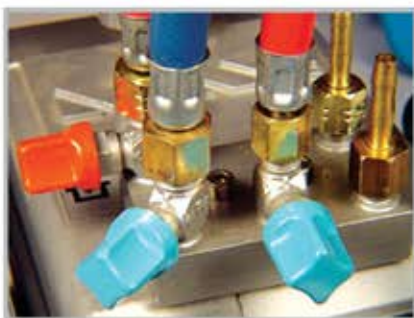
جعبه تقسیم گاز، ورودی گاز و هوا و شیرهای کنترل Oxygen / pre - heat gas supply cutting valve
