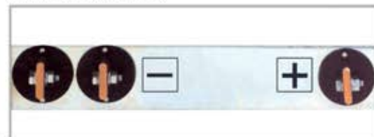
محل اتصال کابل و انبر گوجینگ Connector for cable & torch
