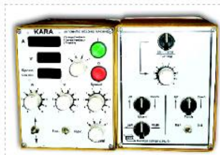
جعبه کنترل تأمین حرکت های عمودی و افقی و حرکت دورانی ستون Control box for vertical & horizontal movements for 1300m and circular movement of column & PEG1 welding
